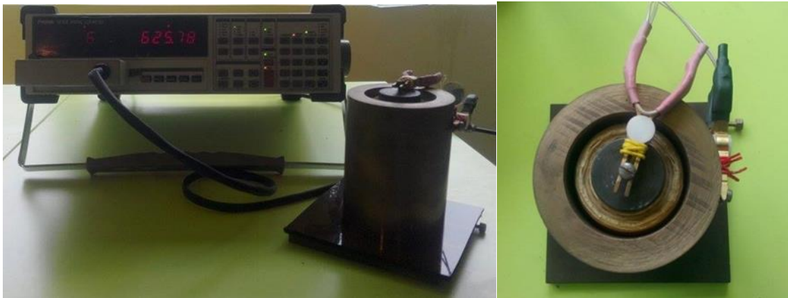
Figura 1. Dispozitivul experimental pentru determinarea rezistenței electrice și a capacității electrice
